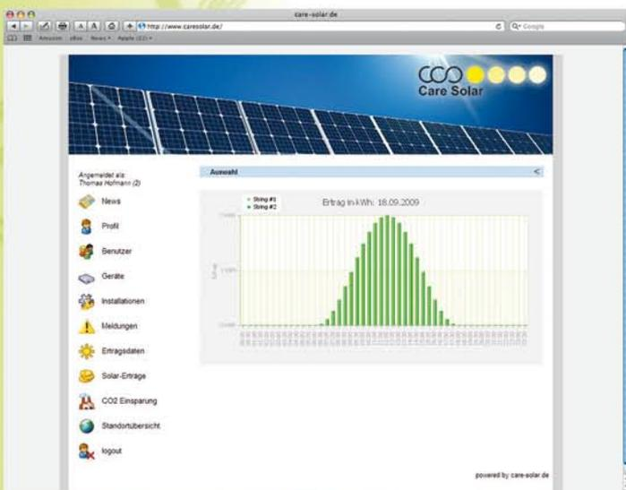
Das Web-Portal stellt die erfassten Daten transparent und übersichtlich dar und ermöglicht ein effektives Monitoring. Über die Web-Oberfläche kann die PV-Anlage weltweit von jedem beliebigen Standort aus überwacht werden. Damit wird auch das Monitoring großflächiger Anlagen, die räumlich weit auseinanderliegen, ermöglicht. Die transparente Darstellung des Datenbestandes und die Analyse historischer Daten bietet eine profunde Grundlage für eine langfristige, lückenlose Überwachung.
